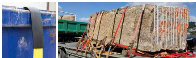
Perfekt geschützte Zurrgurte an rauen Scheuerstellen - Ihre Sicherheit für einwandfreie Transporte Perfect protection for your lashing straps - The extra safety feature for your perfect delivery
